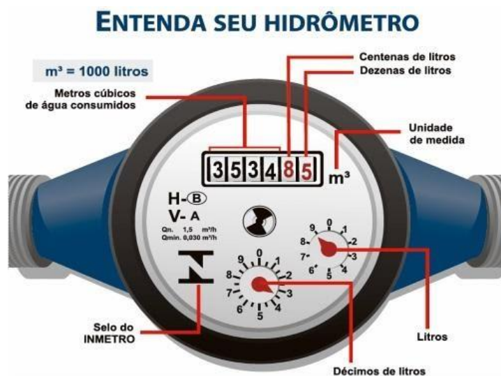
Figura 3 – Hidrômetro. Fonte: Magno (2020).
