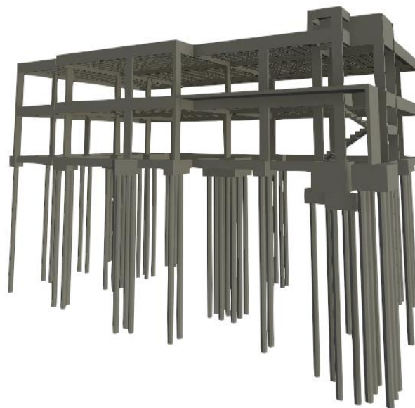
Figura 06: Modelo do projeto estrutural.
