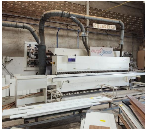
Figura 11: Setor de fitagem Fonte: INDUSTRIA S.A.
