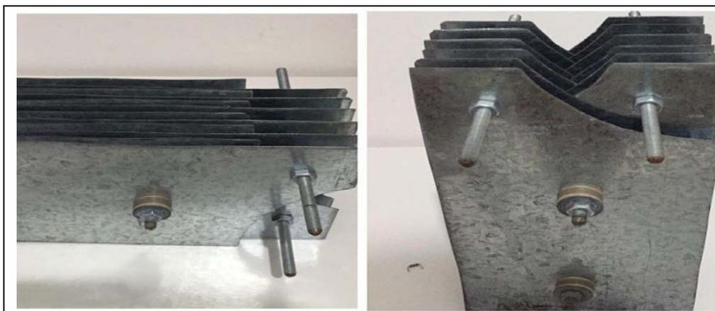
**Figura 4.** Arranjo de placas monopolares conectadas em paralelo.
