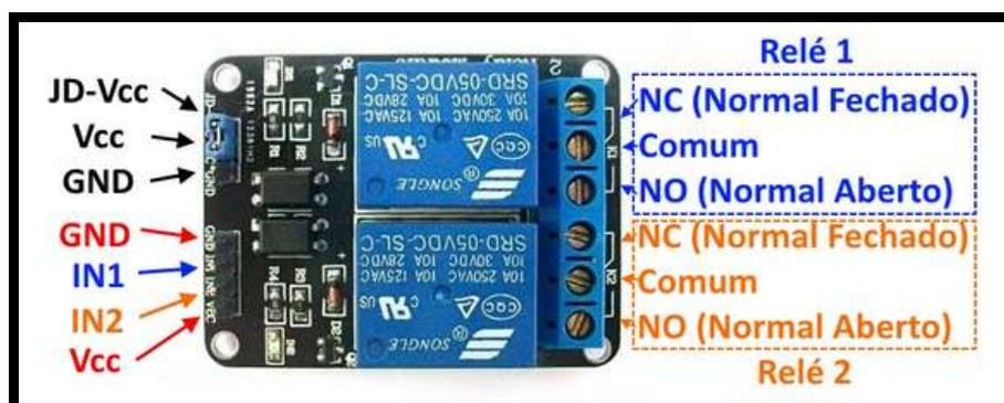
Figura 28: Pinagem do Módulo relé 2 canais
