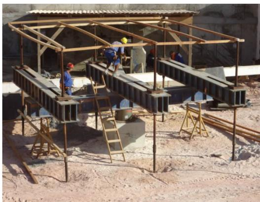
**Figura 10.** Sistema de reação.
